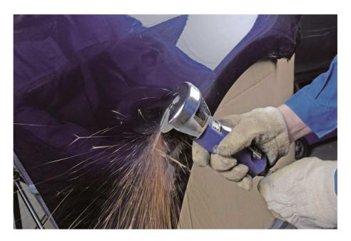
Das Werkzeugsystem Norton Blue Fire ist zum Einsatz auf Druckluft- oder Elektro-Geradschleifern ausgelegt. Das Anwendungsspektrum ist breit gestreut.
